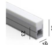
Profilo interno completo di diffire in PMMA
