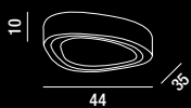
6472 Plafoniera in vetro bianco soffiato e acidato Ceiling lamp in white etched and blown glas
