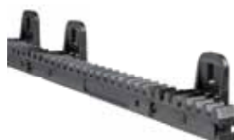
AJ91111 Cremagliera (V6) in fibra di nylon con anima in acciaio ed asola di fissaggi modulo 4 (ante max 600 Kg) € 22,00 (prezzo al mt.)
