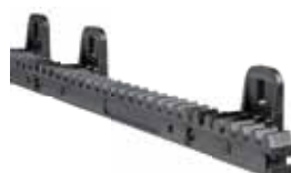
AJ91111 Cremagliera (V6) in fibra di nylon con anima in acciaio ed asola di fissaggio modulo 4 (ante max 600 Kg) € 22,00 (prezzo al mt.)
