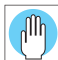
Simbolo che indica la temperatura delle superfici toccabili Symbol indicating the temperature of the touchable surfaces
