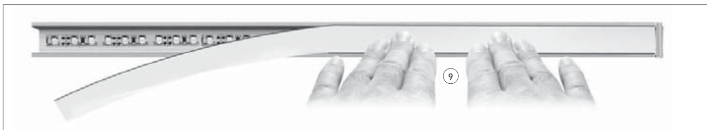
Inserire la copertura sul prodotto esercitando una leggera pressione. È consigliato iniziare da un lato e proseguire premendo delicatamente (9). Fit the cover on the product, using a small amount of pressure. Start from one side and proceed along it, pressing gently (9).
