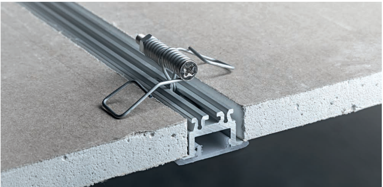
Molla a pressione Foro incasso larghezza 19 mm: Posizionare inizio-fine +1 ogni 50 cm. Spring for recessed ceiling. Recessed hole width 19 mm. Place: beginning, end and 1 every 50 cm
