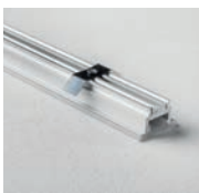
Molla a pressione Foro incasso larghezza 19 mm: Posizionare inizio-fine +1 ogni 50 cm. Spring for recessed ceiling. Recessed hole width 19 mm. Place: beginning, end and 1 every 50 cm
